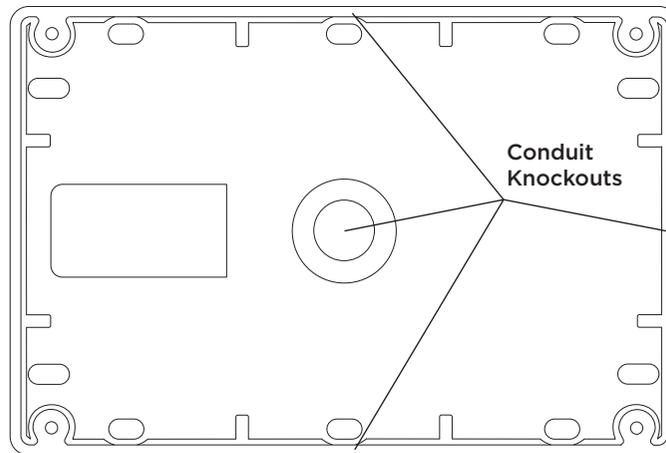
Figure 2: Conduit Knockouts
